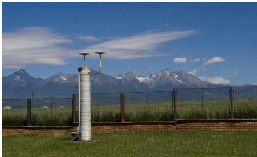
Obr.25 Referenčná stanica GANP (Gánovce) s dvoma anténami.
