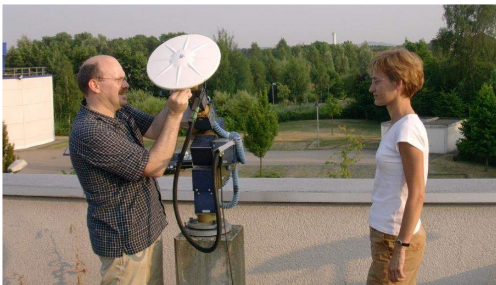
Obr.11 Anténa referenčnej stanice SKPOS pri kalibrácii na robote spoločnosti Geo++.
