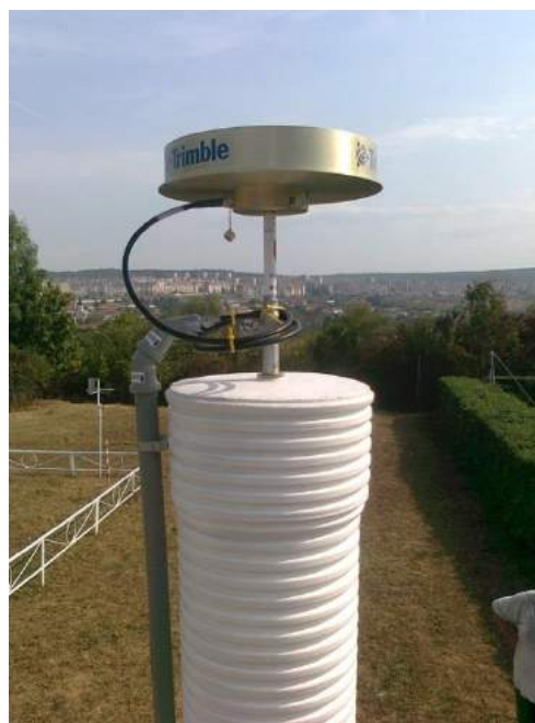
Obr.5 Ukážka modulu s centračnou tyčou zabezpečujúcou stabilizáciu a nútenú centráciu referenčných staníc SKPOS na streche budovy (vľavo) a na pilieri (vpravo).
