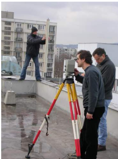
Obr.9 Určovanie výšky SKPOS referenčnej stanice GKU1 niveláciou v roku 2006.
