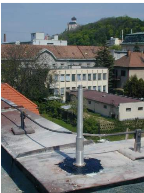
Obr.5 Ukážka modulu s centračnou tyčou zabezpečujúcou stabilizáciu a nútenú centráciu referenčných staníc SKPOS na streche budovy (vľavo) a na pilieri (vpravo).
