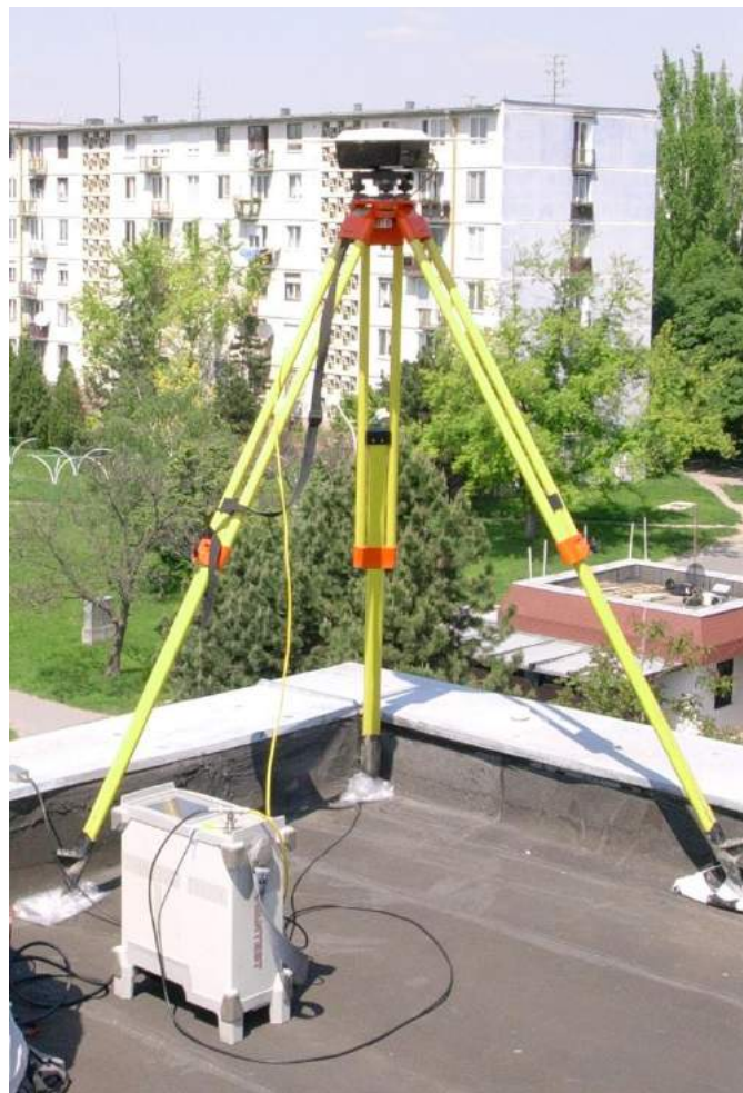
Obr.6 Ukážka merania interferometrie na referenčných staniciach SKPOS spektrálnym analyzátorom.
