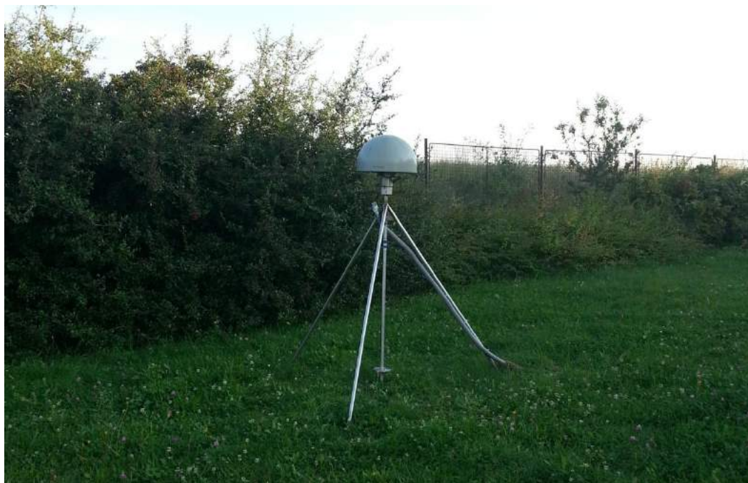
Obr.29 Ukážka stabilizácie referenčnej stanice BASV formou vŕtanej tyčovej stabilizácie.
